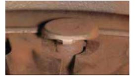
**Rebite com desgaste excessivo**
